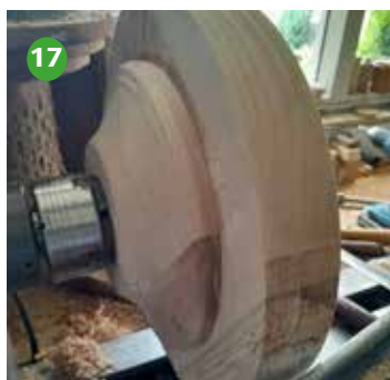
Foto 13 t/m 16 Het bovenstuk op het onderstuk lijmen, daarna de schaal uithollen.
