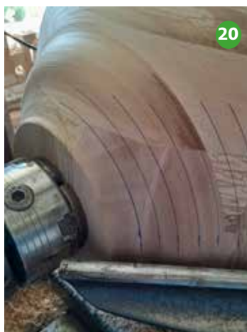
Foto 19 Als de schaal aan de binnenzijde uitgedraaid is, dan de vorm van de schaal aan de buitenzijde draaien. Wanddikte ca. 10 mm.
