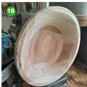
Foto 17 en 18 De opspanning en de uitholling.
