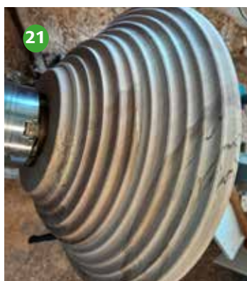
Foto 17 en 18 De opspanning en de uitholling.
