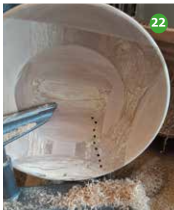
Foto 20 en 21 De zijkant belijnen in tweemaal vijf delen. Tussen deze lijnen hollen maken van ca. 4 mm diep.
