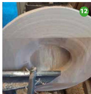
Foto 11 en 12 De onderzijde opgespannen op de opspankop, daarna de bovenzijde vlakdraaien.
