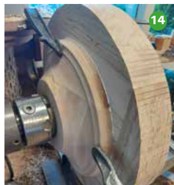
Foto 9 en 10 De vorm draaien van de onderzijde en een kamer draaien voor de opspankop.
