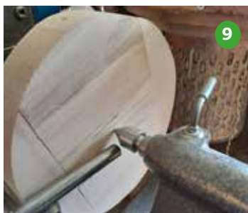
Foto 7 en 8 Op het onderstuk een schroefplaat schroeven, zodat je een kamer kunt draaien voor de opspankop op de onderzijde.
