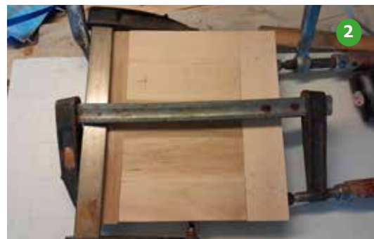
Foto 2 Ook weer van afvalhout; beuk, 60x60 mm, gekregen van een dorpsgenoot. Verlijmd voor het bovenstuk 42x42x6 cm. Zodanig verlijmd dat er zo min mogelijk kopshout in het zicht komt.
