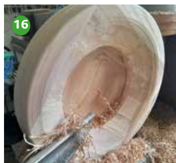
Foto 13 t/m 16 Het bovenstuk op het onderstuk lijmen, daarna de schaal uithollen.
