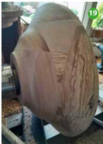
Foto 19 Als de schaal aan de binnenzijde uitgedraaid is, dan de vorm van de schaal aan de buitenzijde draaien. Wanddikte ca. 10 mm.
