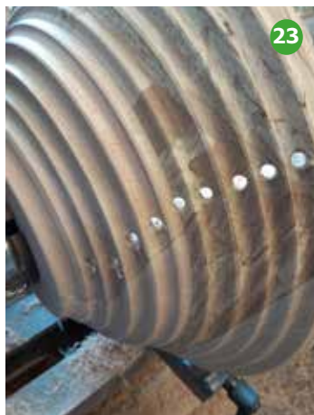
Foto 22 en 23 Vanuit de holletjes aan de buitenzijde gaatjes boren van 8 mm.
