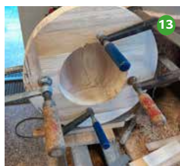
Foto 11 en 12 De onderzijde opgespannen op de opspankop, daarna de bovenzijde vlakdraaien.
