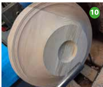
Foto 9 en 10 De vorm draaien van de onderzijde en een kamer draaien voor de opspankop.
