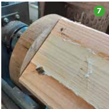
Foto 5 Het geheel verlijmen zodat je een holle blok krijgt van 160x160 mm.
