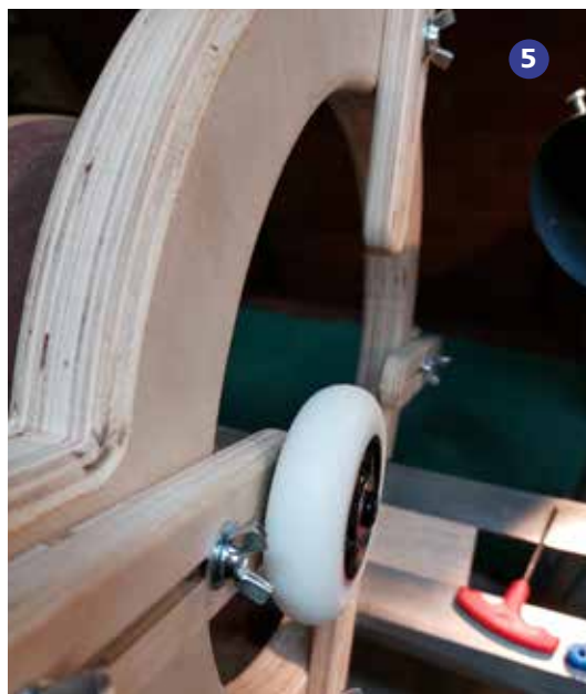
Foto 5: De wieljes binnen de ring gemonteerd heeft mijn voorkeur. De armen kunnen echter ook – zoals getoond op de foto – omgedraaid gemonteerd worden waardoor de maximale diameter toeneemt.
