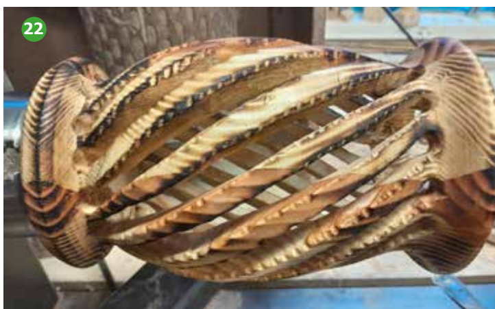
Foto 20 Nadat de groeven gezaagd zijn met de Dremel op de zijkanten van de ribben holletjes te fraizen
