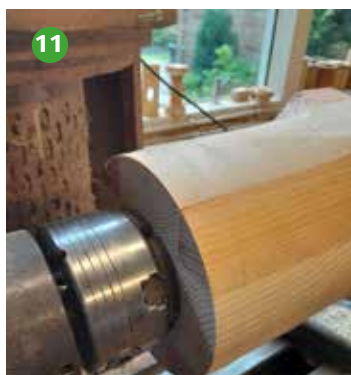
Foto 11 Het blok gedraaid en op de opspankop bevestigd.
