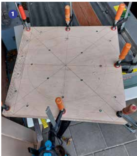
Foto 1: Twee lagen 18mm dik multiplex, geschroefd (op de later weg te zagen delen) en gelijmd.
