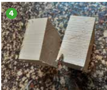
Foto 4 Eén van deze blokjes voor de bodem, gelijktijdig verlijmen met de twee delen van foto 3 en 2x 45x70 mm.
