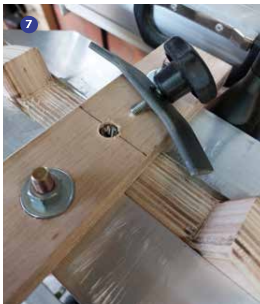
Foto 7: Voor de bevestiging op het bed heb ik aan de onderzijde van het geleideplaatje een inschroef- of rampamoer gebruikt.
