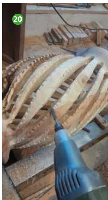
Foto 20 Nadat de groeven gezaagd zijn met de Dremel op de zijkanten van de ribben holletjes te fraizen
