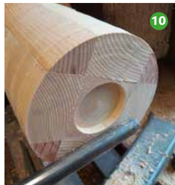
Foto 10 Zorg dat de onderkant goed vlak is en de kamer diep genoeg.
