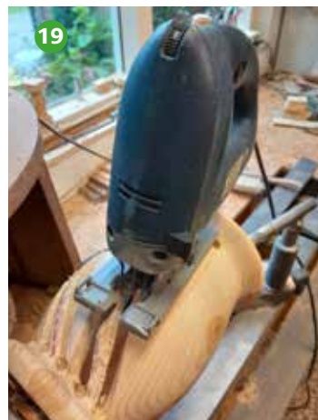
Foto 19 De groeven uitzagen met de decoupeerzaag.
