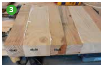
Foto 3 2x 45x45 mm. en 1 x 45x70 mm. verlijmen, dat twee maal uitvoeren.
