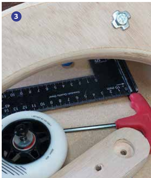
Foto 3: Inslagmoeren fixeren de bouten waarmee de armen gemonteerd worden. De wieljes worden verzonken gemonteerd zodat de bevestiging niet in de weg zit als de armen omgedraaid worden om de maximale diameter te vergroten.
