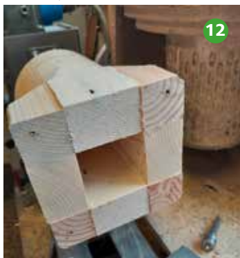
Foto 12 Zonder tegen-center draaien, maar je kunt voor de zekerheid een vierkant plaatje er tegen schroeven voor de tegencenters.
