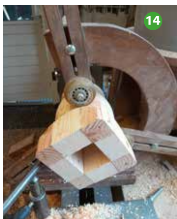
Foto 14 De bril geplaatst om de bovenzijde te draaien.
