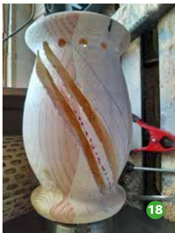
Foto 18 Het uitzagen van de groeven, vooraf aan de boven en onderkantgaten te boren alvorens geheel op de vaas uitgeslagen.
