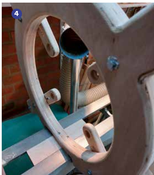
Foto 4: De bril wordt in eerste instantie met twee houtschroeven bevestigd op het geleideplaatje dat in de sleuf van het bed valt..
