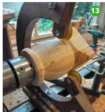
Foto 13 Eerst de onderzijde het model draaien zoals is aangegeven op afbeelding 1. En dan de bril plaatsen.
