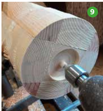
Foto 9 Een kamer te draaien voor de opspankop, aan de onderzijde.
