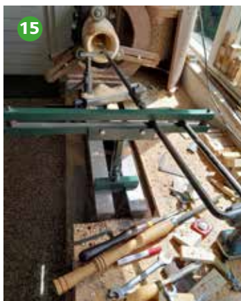
Foto 15 Gewerkt met het diep uithol systeem, vanuit de achterzijde gezien.
