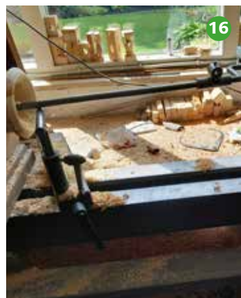
Foto 16 Uitholsysteem vanuit de voorzijde gezien.
