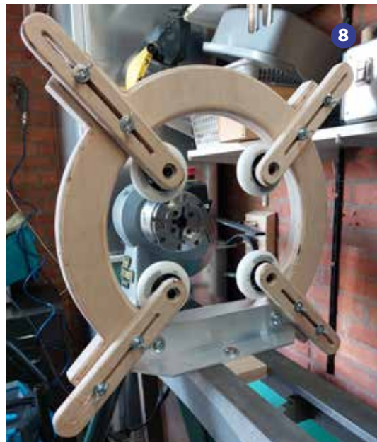
Foto 8: Twee aluminium hoekprofielen – met M8-bouten verbonden aan de ring en het geleideplaatje – maken het geheel tot een stijve constructie. Tijdens een test met ruim 1800 toeren bleef de bril mooi stil en trillingvrij.
