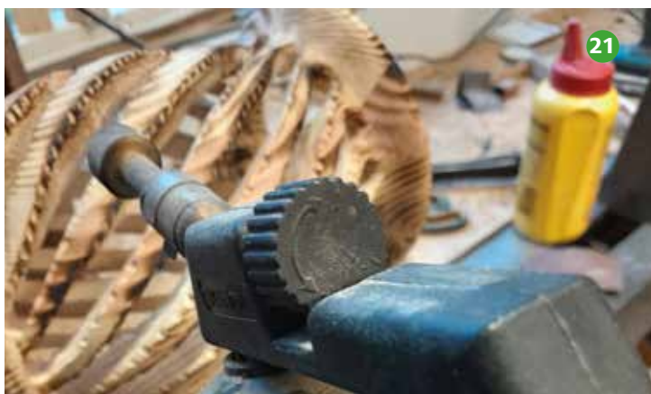
Foto 18 Het uitzagen van de groeven, vooraf aan de boven en onderkantgaten te boren alvorens geheel op de vaas uitgeslagen.
