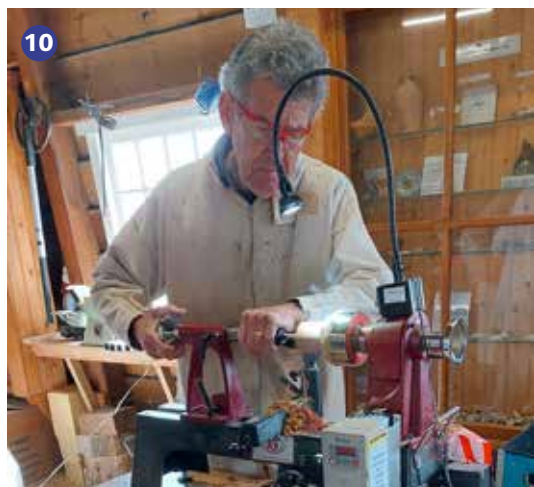
Foto 10 Martien van Vliet boort een gat waar later schroefdraad in aangebracht wordt.
