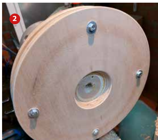
Foto 4 Uit 6 mm multiplex een tussenplaatje gezaagd en daarop het holle 'bedje' gelijmd. Eerst zo goed mogelijk gecentreerd monteren, daarna pas afdraaien en uithollen. Ook hier de indexfunctie gebruikt om drie schroeven M5 netjes te verdelen.
