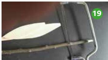
Foto 19 Voor de bevestiging van het blad op de steel sleufjes zagen voor de verbinding van het blad, zie ook foto 18
