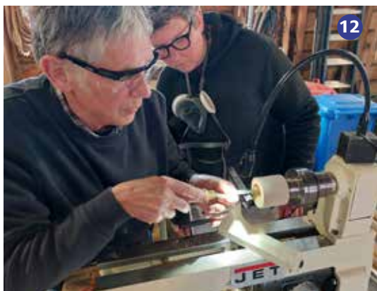
Foto 10 Martien van Vliet boort een gat waar later schroefdraad in aangebracht wordt.
