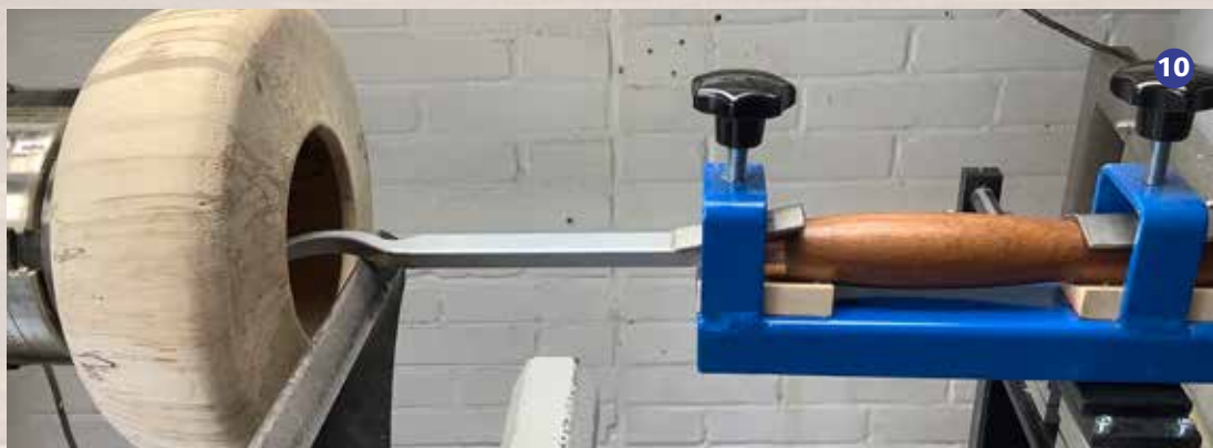
Foto 10 Het systeem met de uitholguts met snijmes.
