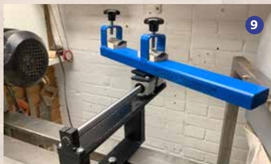
Foto 9 Uitschuifbaar tot naast het bed wat een grotere uitholhoek geeft.
