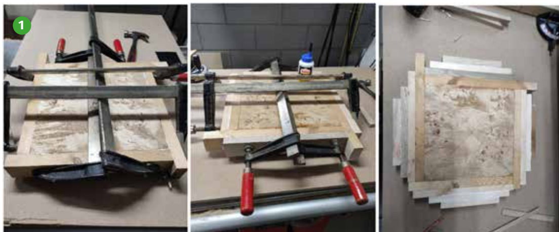
Foto 1 Dit drieluik geeft de opbouw weer waaruit een cirkel kan worden gezaagd (decoupeerzaag) wat het draaien vereenvoudigt en veiliger maakt.
