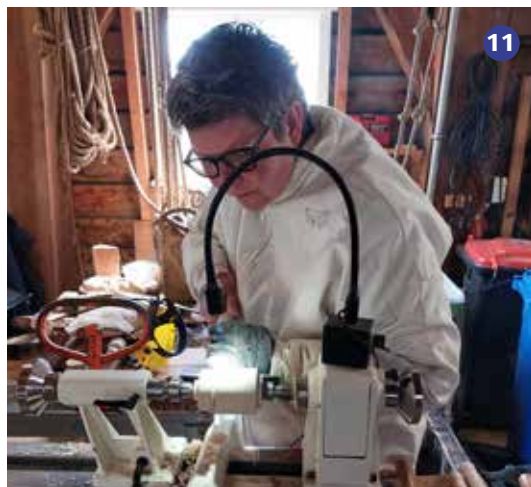
Foto 11 Annerose is bezig met de voorbereidingen voor het zgn. schroefdraad strelen.
