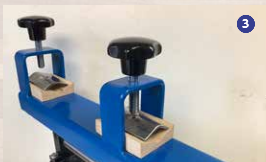
Foto 3 Klemplaatjes om de guts stevig vast te zetten.
