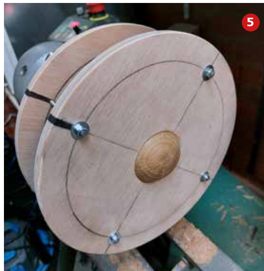
Foto 4 Uit 6 mm multiplex een tussenplaatje gezaagd en daarop het holle 'bedje' gelijmd. Eerst zo goed mogelijk gecentreerd monteren, daarna pas afdraaien en uithollen. Ook hier de indexfunctie gebruikt om drie schroeven M5 netjes te verdelen.
