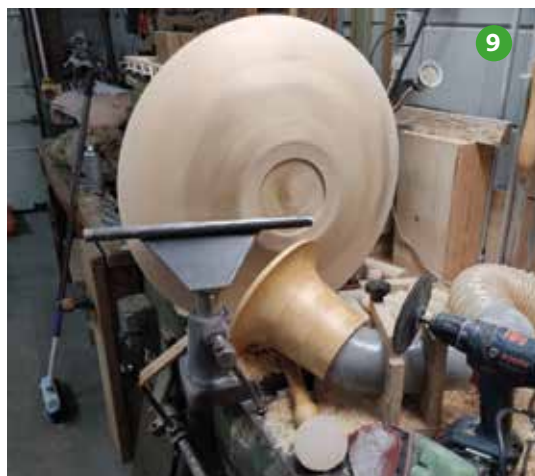
Foto 9 De onderzijde (draaiend) op 430 rpm (helaas laagste toerental) en klaar om te schuren met behulp van:
