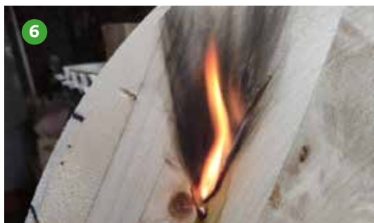
Foto 6 Tijdens het afdraaien begonnen er houtsplinters aan de beitel te plakken, oorzaak
