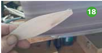
Foto 18 De onderzijde van het blad scherp afschuiven voor de bevestiging aan de steel.
