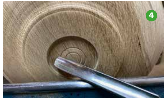
Foto 4 Ik begin met een kamertje te draaien waar de chuck net invalt. Diep 5mm. Een paar cirkels voor de sier met de platte beitel aangebracht. Ik werk graag met een kamertje zodat je later de schaal nog eens makkelijk terug op kan spannen.
