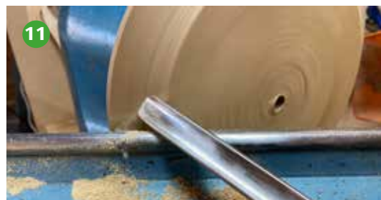
Foto 11 De schuine buitenrand afgedraaid, zodat het afgebroken stuk weg is. De schaal is hierdoor van 25 naar 24 cm gegaan.
