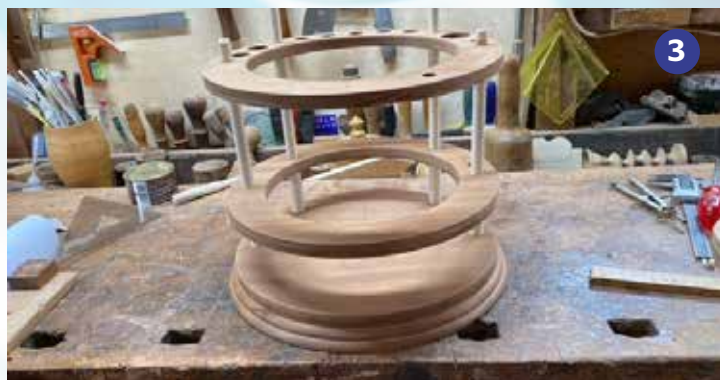
Foto 3 Hier de basis gedraaid en de kolommen met de ringen passend gemaakt. De ringen moeten nog gehalveerd worden.
