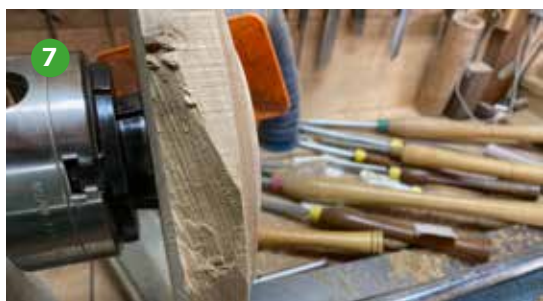
Foto 7 Onverwachts kwam er bij een scheurtje dat ik niet had gezien een stuk eiken los en moest ik dus mijn vorm iets veranderen.
