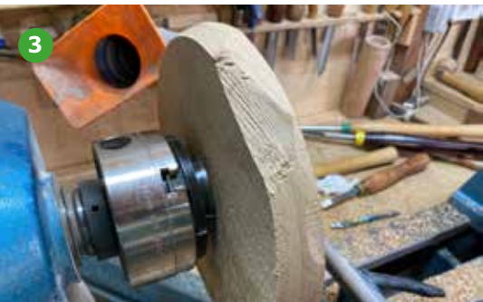
Foto 2 De schaal wordt op een in de chuck geplaatste wormschroef gedraaid.
