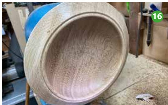
Foto 16 Nu schuren met korrel 180, 240, 320 en 400 en de schaal is af.
