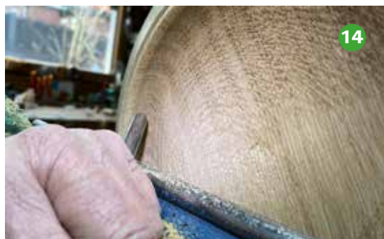
Foto 14 Met een 9mm vormguts hol ik de onderkant /binnenkant van de rand uit.
