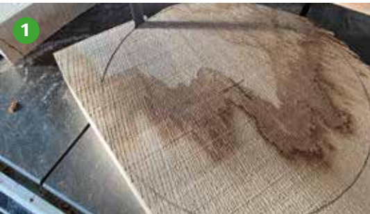
Foto 1 Uit een plaat eiken afkomstig uit de Keukenhof, "vals kwartier" gezaagd, dik 5,2cm, kan ik een schaal zagen van ø25cm.
