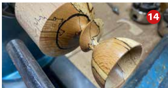
Foto 14 De wobble chuck wordt weer verder gedraaid om de 2e wobble te draaien. Ook deze wordt weer globaal afgetekend maar iets groter als de 1ste.
