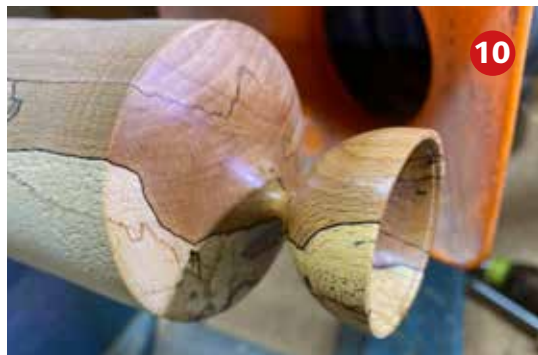
Foto 10 Het 1ste vlak is gedraaid, geschuurd en weer afgewerkt.
