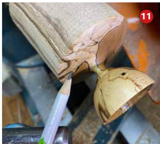
Foto 11 Nu wordt de wobble chuck weer gedraaid en teken ik ongeveer af tot hoever ik het af ga draaien. De verdraaiing van de chuck is een beetje op gevoel (hier 10mm) en met wat ervaring als je het meer gedaan hebt.
