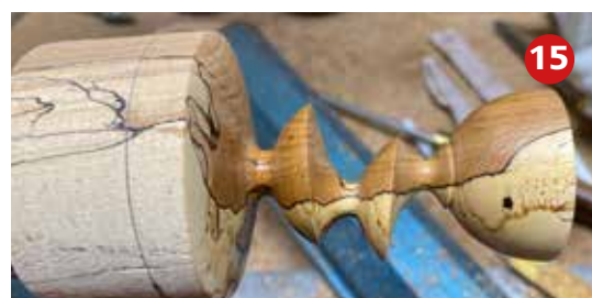
Foto 15 Ook de 2e wobble en 3e vlak is gedraaid en afgewerkt. Met een potlood lijn geef ik aan tot hoever de schroeven in het hout zijn gedraaid.
