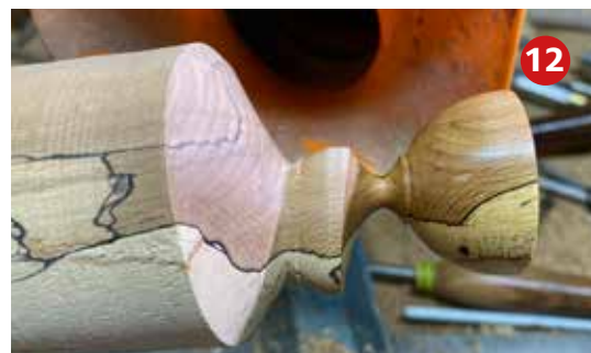
Foto 12 Het 2e vlak is gedraaid en de 1ste wobble (zo noem ik het maar) wordt in de juiste vorm gedraaid.
