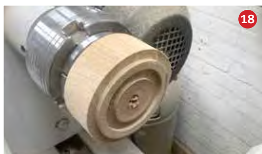
18 Aan deze kant van het deksel weer een kamertje voor de chuck gedraaid.
