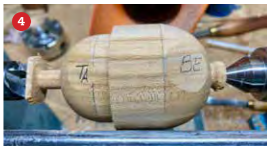
4 De bovenkant wordt ingestoken en rondgedraaid (ø55mm) en de plaats van de pootjes wordt zichtbaar.
