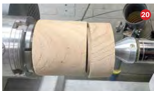
20 Deksel op het potje met behulp van het tegencentreer.
