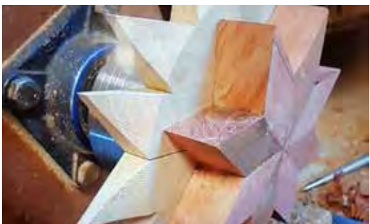
23. Lagen 1 en 2 aan elkaar gelijmd en aansluiting maken voor laag 3.
