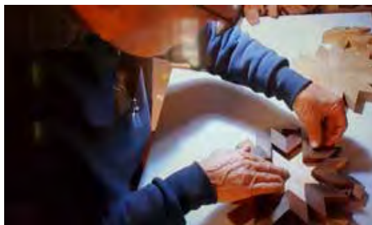
13. Laag 4 letterhout lijmen op laag 3 Essenhout op hulplatjes van 14 mm.
