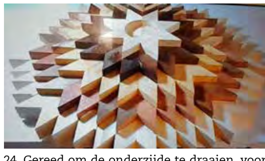
24. Gereed om de onderzijde te draaien, voor aansluiting van de opspankop ook weer met dubbelzijdig plakband het hulpstuk geplakt.
