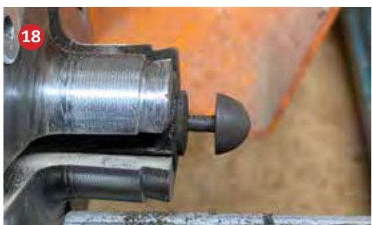
18 De ogen en neus wordt gedraaid van ebben en bloodwood. Het steeltje heeft een diameter van 4mm.
