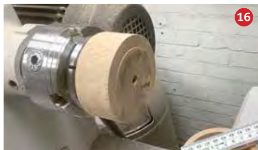
16 Deksel ingespannen en afgedraaid.
