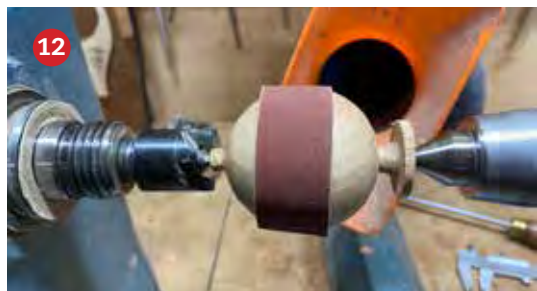
12 Om het hoofd plak ik schuurlinnen met dubbelzijdig plakband om een stukje uit het oor te schuren in de pasvorm van het hoofd.
