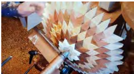
25. De onderzijde draaien voor lagen 1 en 2 verlijmd worden, i.v.m. het splinteren van het hout.
