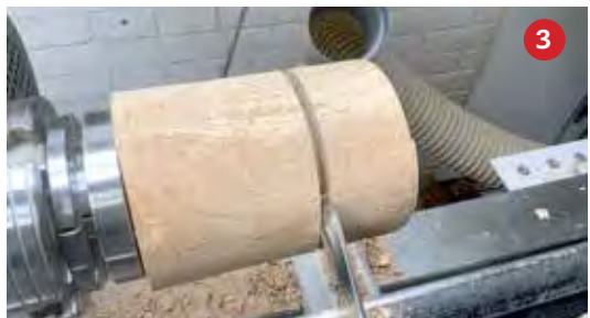
1 Met de afsteekbeitel insteken, niet helemaal doorsteken.
