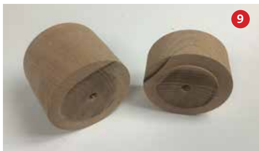
9 Met de handzaag het deksel loszagen.
