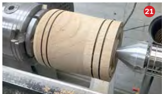
21 Met de guts een wat ander model gedraaid en het deksel is nu gelijk met het potje.
