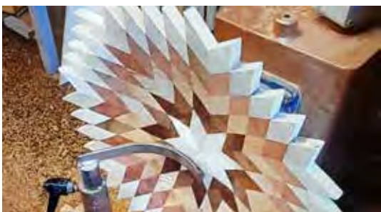
31. De schaal aan de binnenzijde gedraaid.
