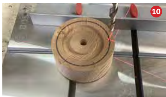
10 In de kolomboor nu de gaten voor de deuvels boren van 8,5 mm LET OP de diepte!
