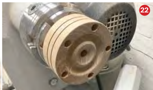
22 deksel opspannen en de bovenkant wat ronder maken en alles goed schuren.
