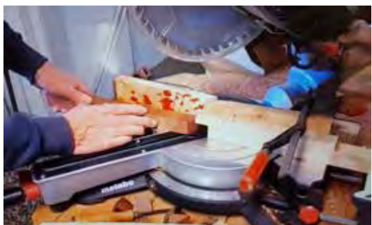
5. Het afkorten van de ruiten, deze goed inklemmen met een hulpstuk, alle zijden moeten 40 mm. zijn, bij latjes van 28x28 mm.
