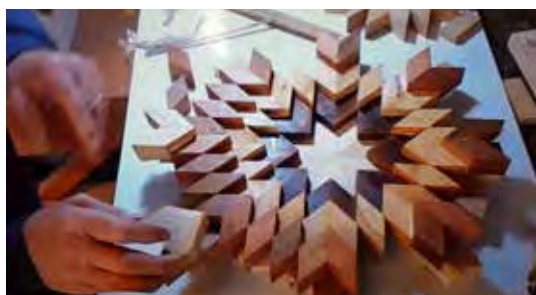
15. Na de 6e laag Bilinga de laatst laag Essen verlijmen, steeds de vullatjes van 14 mm. dik gebruiken.
