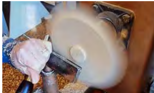
18. Het profileren van laag 1, moet vooraf voor dat laag 2 verlijmd wordt.
