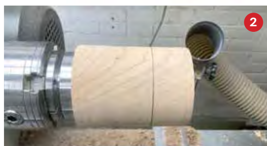
2 Rondgedraaid en op 4 cm van de bovenzijde een streep gezet dit wordt het deksel.
