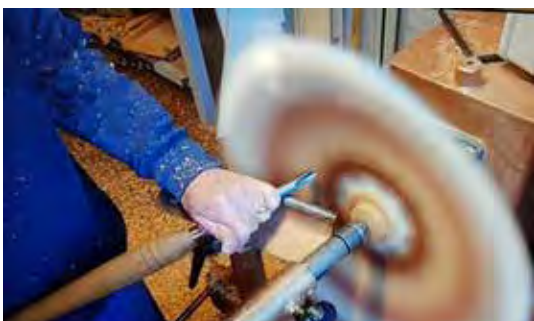
30. T.p.v. het letterhout dat zeer hard is zeer voorzichtig draaien.
