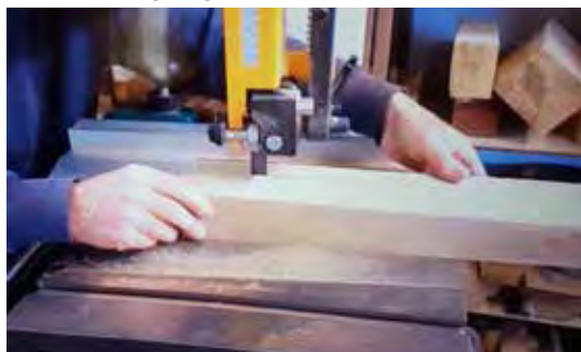
3. Met de lintzaag eerst latten zagen van 29x29 mm.
