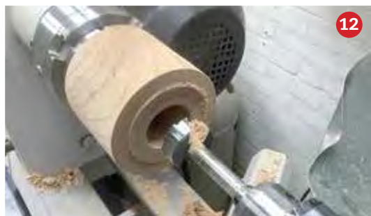
12 Potje ingespannen en met forstnerboor groter gat in gemaakt.
