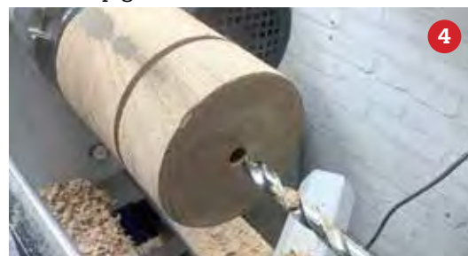
2 aan de bovenzijde met 10 mm boor. Boren tot bijna aan de bodem.
