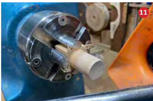
11 De oortjes worden gedraaid ø20m
