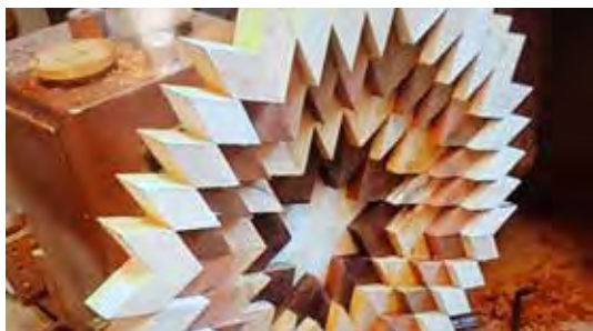
27. De schaal opgespannen op laag 1, gereed voor het draaien met tegencent. Het is oppassen geblazen i.v.m. de scherpe einden van de ruiten.
