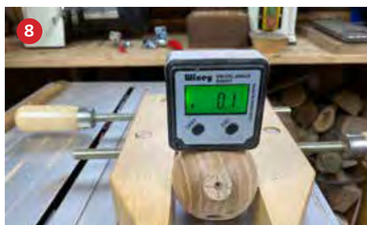
6 Het lijf wordt in een houten lijmtang geklemd en zo zuiver mogelijk afgesteld.
