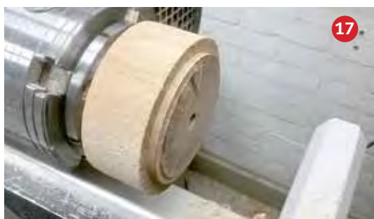
17 Diameter potje uitgezet op deksel en afgedraaid tot het past op het potje.
