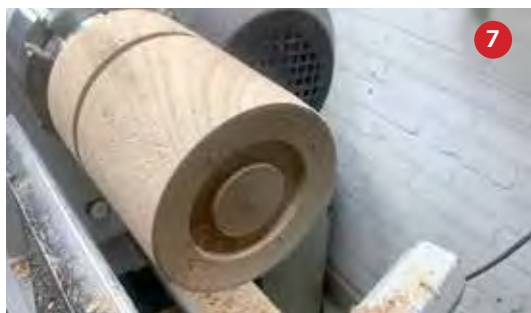
7 Nu aan de onderkant het kamertje voor de chuck maken.
