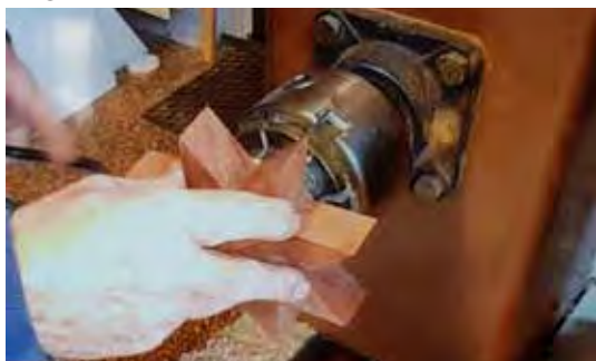
19. Laag 2 ook voor profileren, voor dat het op laag 1 verlijmd wordt.
