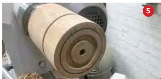
5 Bovenzijde kamertje voor de chuck en 5 gaten verdeeld aftekenen in het midden.
