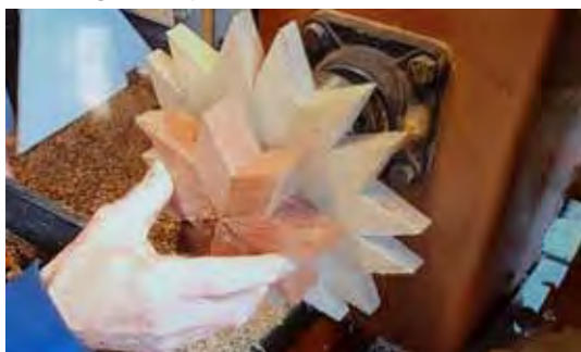
20. Laag 2, Bilinga vooraf passen op laag 1
