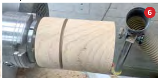
6 Omdraaien en met deksel vastzetten in de chuck.
