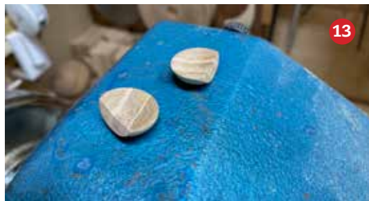
13 De oortjes. Deze worden later op de kop gelijmd met behulp van cocktail prikkers en seconden lijm.
