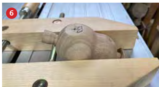
6 Het lijf wordt in een houten lijmtang geklemd en zo zuiver mogelijk afgesteld.
