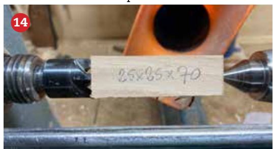
14 Voor de voorpoten wordt een houtje ingespannen 25x25x70mm.
