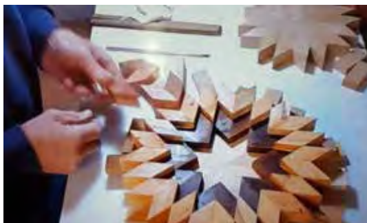
14. Laag 5, Taxus verlijmen op laag 4.
