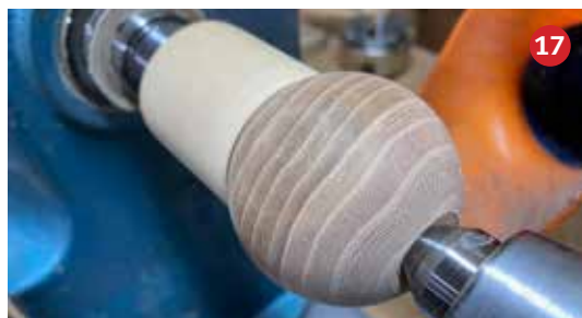
17 Om de kop mooier op het lijf te laten passen ruim ik het gat voor het lijf iets op.
