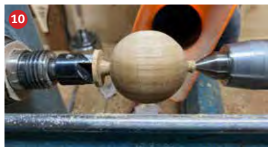
10 De kop wordt gedraaid, afmeting ø60x65mm (eivorm) Hier wordt een gat van ø12mm geboord om de kop op het lijf te plaatsen.
