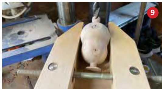
9 Nu kunnen de gaten ø12mm worden geboord voor de voor en achterpoten. Ik doe dit met een kolomboor.
