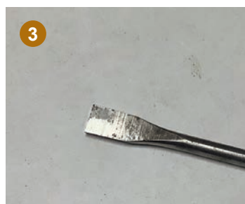
3 De boor met de voorkant afgeslepen.
