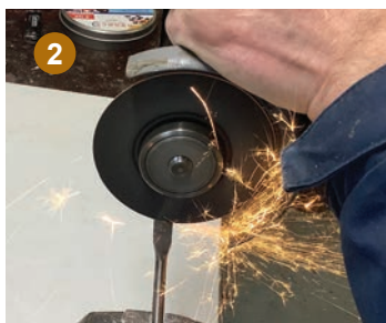
2 Het voorste deel afslijpen zodat de bovenzijde recht is.
