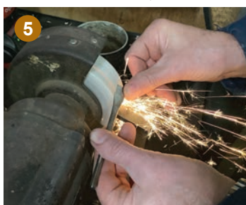
5 We slijpen een schuine hoek aan de speedboor.
