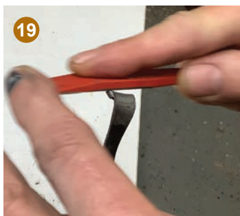
19 Met de diamantvijl de vouw slijpen.
