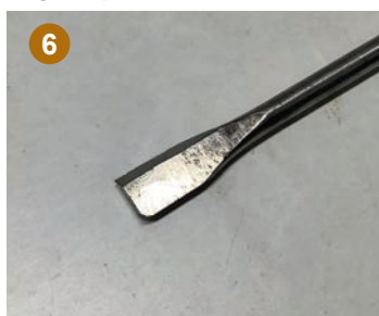
6 De boor met schuingeslepen kant.
