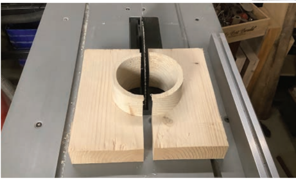
In de pvc pijp een gat geboord en daarna in de lengte door midden gezaagd en d.m.v. een slotboutje en vleugelmoer de pijp op de halve cirkels gemonteerd. Let op De buis moet langer zijn dan de breedte van de schuurplank.
