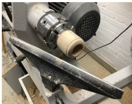
De aansluiting voor de stofzuiger gedraaid en in de pvc pijp gelijmd.
