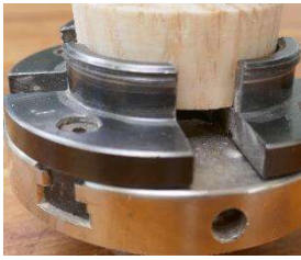
Fout! Chuck omsluit werkstuk niet. Te grote opening tussen de bekken.
