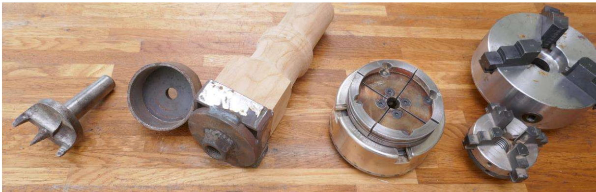
Van L .naar R.: Meenemer, Inslagbus rond en vierkant, Chuck met zwaluwstaart bekken, 4-, en 3 Klauw-plaat
