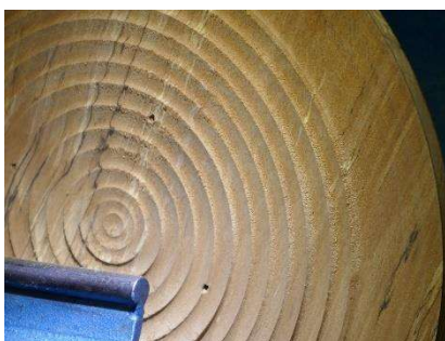
Ringetjes/gleufjes insteken. De gaten v.d opspanflens zijn nog zichtbaar
