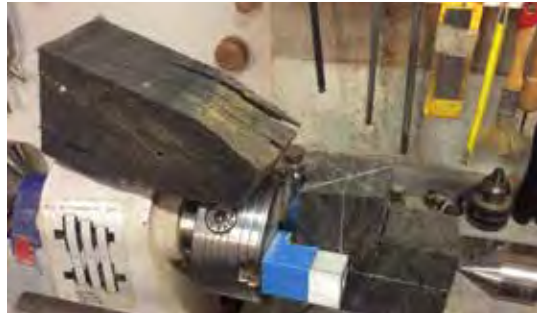
Stuk Romeins waterputhout en ébauchon opgespannen op de draaibank.
