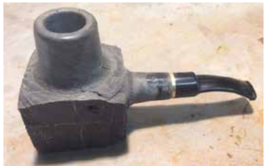
Tussenfase – Kop en steel zijn gedraaid, testen van een mondstuk.
