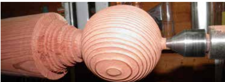
De bolvorm met staalborstel bewerkt waardoor het zachte hout tussen de nerf wordt weggeslagen.
