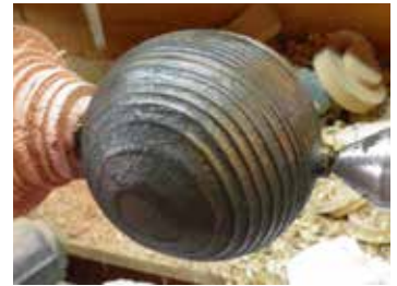
De bolvorm bewerkt met reactie vloeistoffen.
