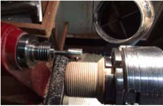
De foto's Detail haakse beitel en detail schuine beitel laten de beitels zien en de schroefdraad.
