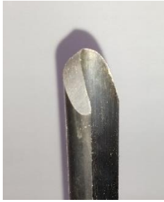
Foto onder: De 'schalenguts', Het Engelse staaftype, geslepen 38° en met vingernagel-profiel = ideaal om mee uit te hollen.
