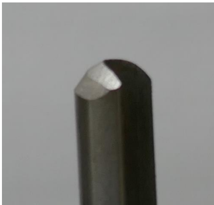
Foto links is de “schaal-bodemguts”. De hiel is weggeslepen en de vouw is 60°.
