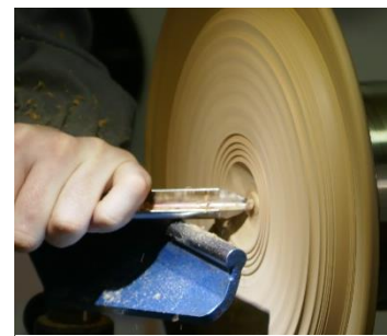
Eerst een kommetje Ø 5cm. maken, dan vanuit de 1e ring naar de kom- en zo de 2 e , 3 e enz
