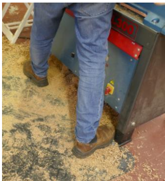
Vóór de kop draaien, voeten staan in een omgekeerde T vorm. gewicht komt op je linker been
