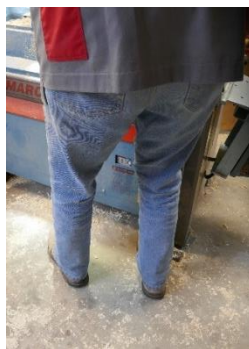
Bij het werken tussen de centers staat het linkerbeen naar voren als er naar links gewerkt wordt.
