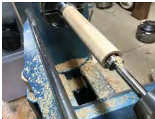
7. Als het hout voor de toren zuiver in de klauwplaat zit wordt een gat geboord van \varnothing 20\text{mm} , diep 2 á 3mm Met een klein beitelje wordt de bodem van het gat mooi vlak gedraaid zodat het puntje van de boor weg is.
