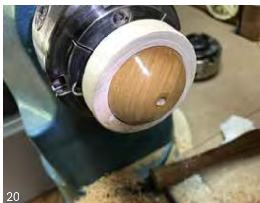
20. Bovenkant ook weer afgewerkt met friction polish.
