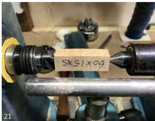
21. Het houtje voor het steeltje op het toelletje is tussen de centers opgespannen.
