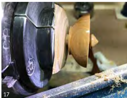
17. De bolle bovenkant van het tolletje draaien, afwerken en afsteken.
