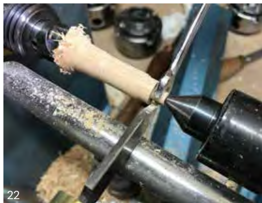
22. Ik draai met behulp van een steeksleuteltje van 6mm het pennetje dat in het toelletje wordt gelijmd.
