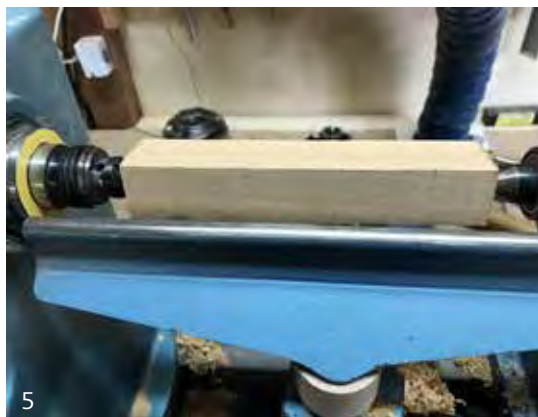
5. Het hout voor de steel is tussen de centers ingespannen en kan worden rond gedraaid.
