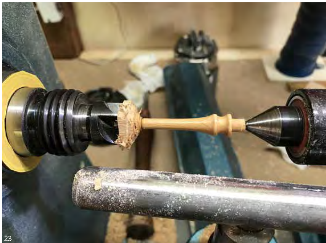
23. De vorm van het steeltje is af en kan afgestoken worden. De toren wordt nu in het voetje gelijmd en het steeltje in het toelletje. Gebruik houtlijm en geen secondenlijm.
