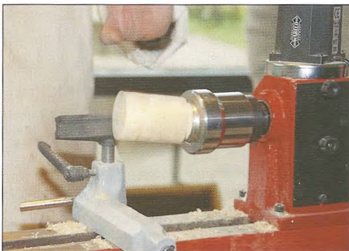
Een blokje hout excentrisch ingespannen in de klauwplaat ontwikkeld door Jean-Francois Escoulen
