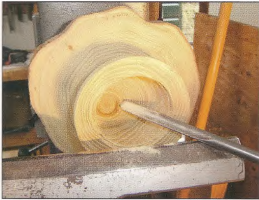
Foto-3: Het op maat snijden van de bodem binnen de kegel. De opening ervan past op de rechte klauwen van mijn klauwplaat. Omdat ik de wanddikte te klein vind voor spreidend klemmen, wordt de voet versterkt met een slangenklem (te zien op foto-7).
