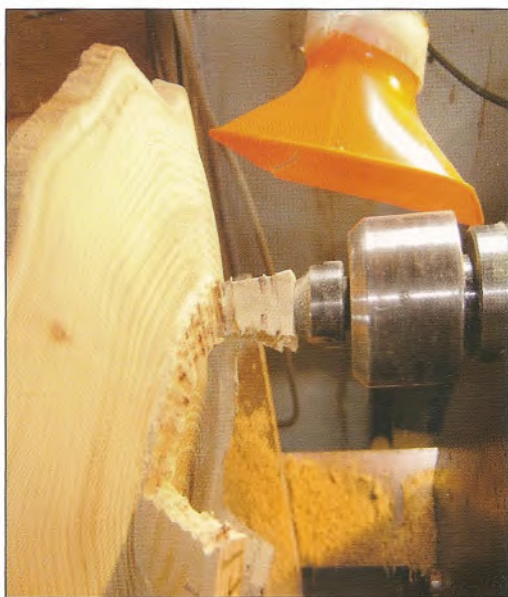
Foto-11: Opnieuw opgespannen om een pootje te draaien. Hier is te zien waartoe het afschuinen op foto-9 dient.
