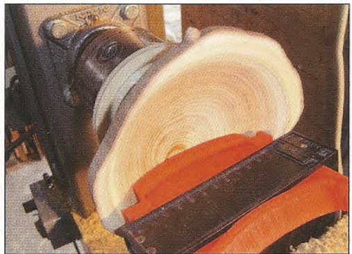
Foto-7: Controle met een profieltaster. Op deze foto is achter de rand van de kom de glimmen-de band van de slangenklem zichtbaar die ter versterking om de onderkant zit.
