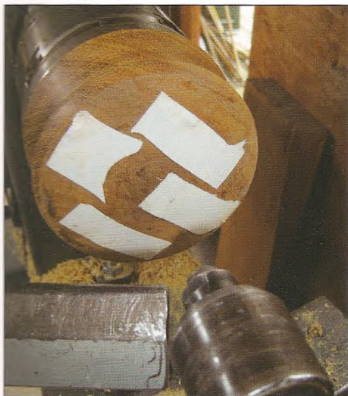
Foto-8: Inmiddels is het hulphoutje op de vaste kop gezet, met daarop een paar strips dubbelzijdig klevend plakband.
