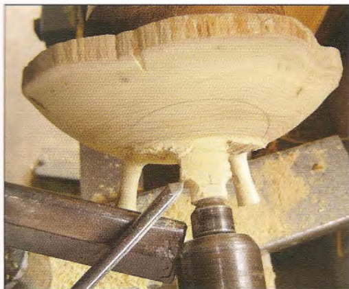
Foto-12: Twee pootjes zijn gedraaid, aan de derde wordt gewerkt. De potloodlijn is een hulpmiddel om de grootte van het werkterrein beter te kunnen zien.
