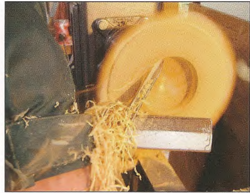
Foto-5: Grof uithollen van de schaal, met de zijkant van de guts steeds vanuit het centrum snijdend (kops hout).
