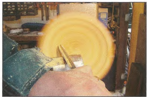
Foto-6: In de slotfase gebruikte ik een schalen-guts, eveneens van binnen naar buiten snijdend.
