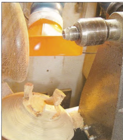
Foto-10: Van de kegelvormige rand is het overtollige verwijderd. Het tegencenter is een ringcenter om spleten van het niet echt droge hout tegen te gaan.
