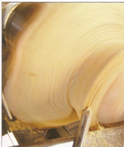
Foto-9: Het afschuinen van de onderkant van de kegel en het verwijderen van het bandje voor de slangenklem. De kom is op het hulphoutje geplakt. Het tegencenter klemt het vast via een extra houtje.
