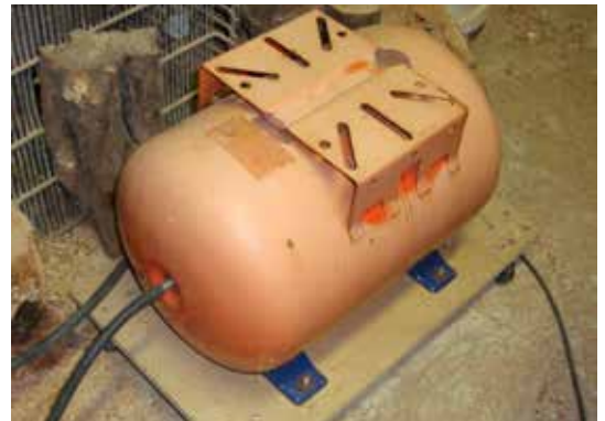
Een buffertank bv. gemaakt van een afgedankte druktank of expansievat. Dit geeft een extra tijd om te reageren van 10-20 sec. bij stroomuitval
