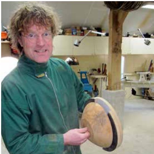
De getordeerde droge voorgedraaide schaal wordt op een schijf met rubber geplaatst om afgedraaid te worden
