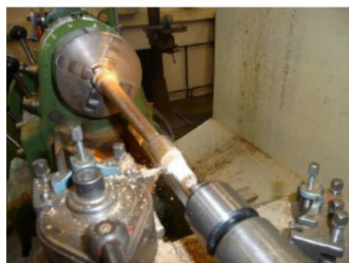
Kegel geklemd in klauw en de centerkop kegels set 1 voorzien van ringen.
