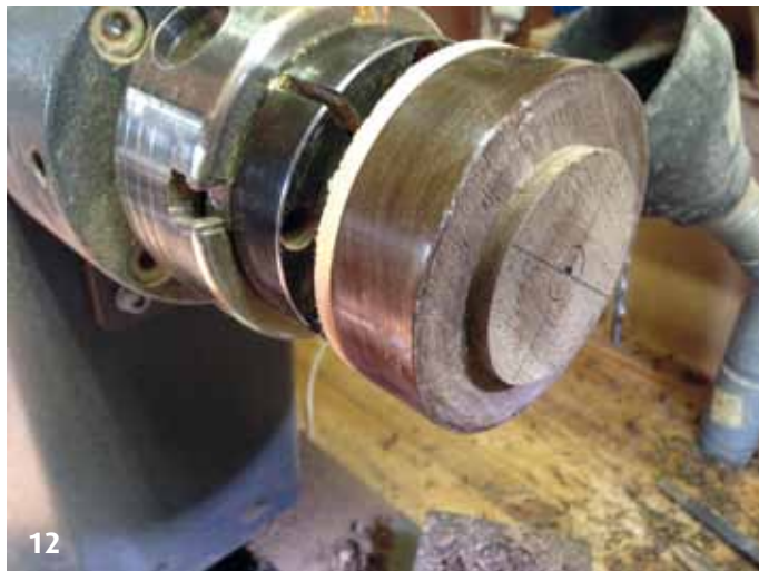
12. Het binnendoosje wordt weer op een hulpstuk geplaatst om de onderkant af te draaien en afwerken. Hoogte doosje 23mm.
