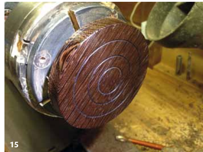
15. Het wengé dekseltje wordt passend in de buitendoos gedraaid en de onderkant wordt afgewerkt..
