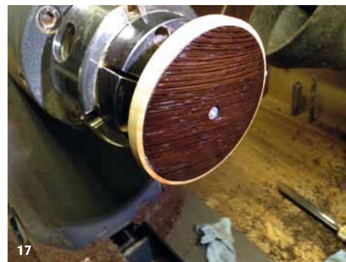
17. Het dekseltje is opgespannen in een hulpstuk zodat de bovenkant kan worden gedraaid en afgewerkt. Nog een gaatje van 6mm boren voor een knopje naar keuze. In het hulpstuk heb ik door het hart een gat geboord van 10mm om het deksel te kunnen lossen als het te vast in het hulpstuk zit.
