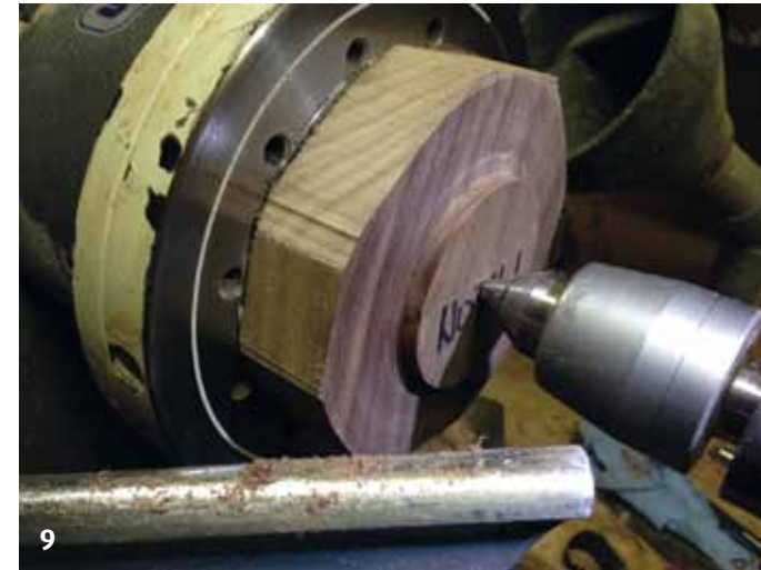
9. Met behulp van dubbelzijdig tapijt tape span ik het stuk notenhout op een opspanplaat en draai een uitsteeksel voor in de chuck.
