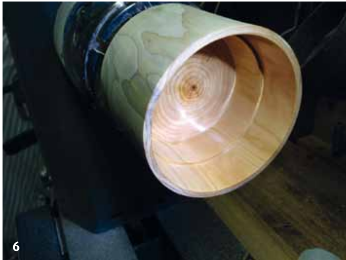
6. De binnenkant van het doosje geschuurd en afgewerkt met friction polish.
