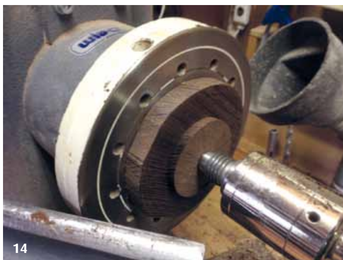
14. Ook het dekseltje plak ik met dubbelzijdig tapijt tape op de opspanplaat en draai weer een uitsteeksel voor in de chuck.
