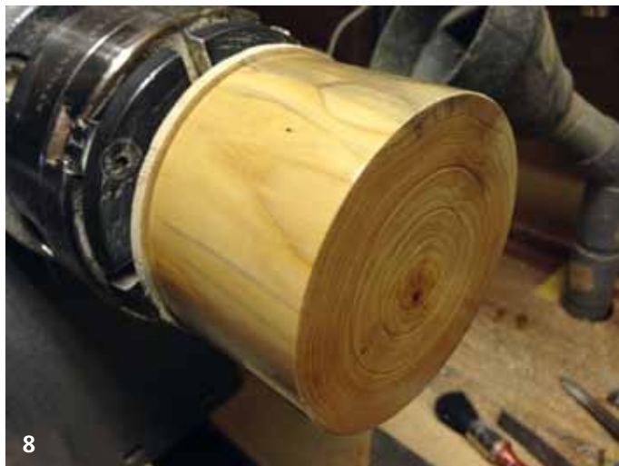
8. Op het resterende stuk in de chuck draai ik een uitsteeksel om het doosje op te spannen zodat de onderkant kan worden afgewerkt.
