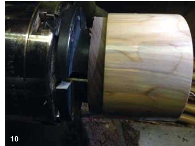
10. Nadat het in de chuck is geklemd word het zuiver passend in het buiten doosje gedraaid.
