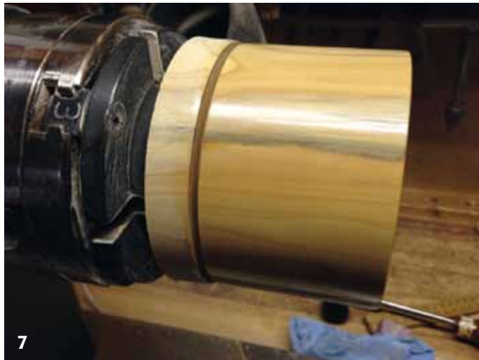
7. Het doosje wordt op 61mm afgestoken.
