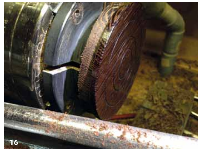
16. De dikte van het dekseltje 3 á 4mm is hier ingestoken.
