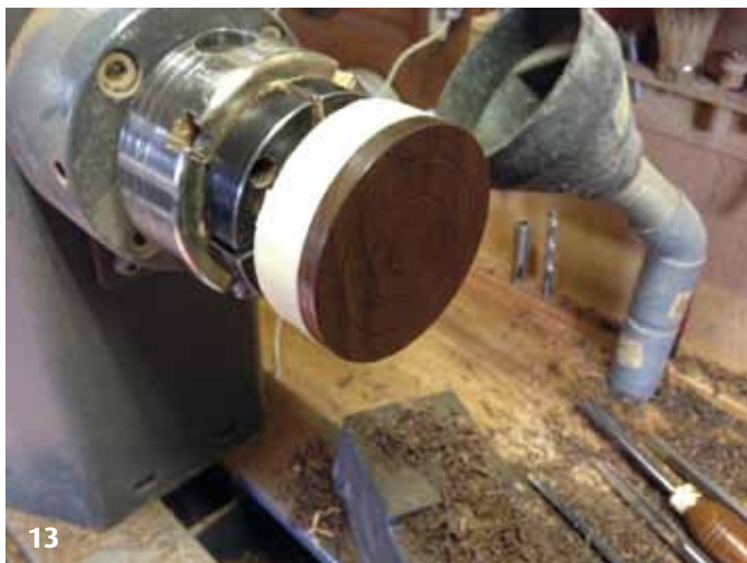
13. De afgewerkte onderkant. Om te voorkomen dat het doosje er af vliegt tijdens het draaien maak ik het extra vast met schilders tape.
