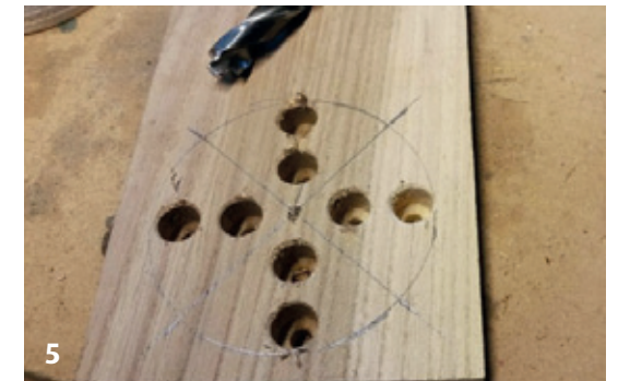
5. De gaten zijn hier al verzonken zodat de schroefkoppen later onder het oppervlak verdwijnen.
