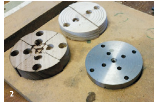
2. De metalen boormal plus twee voorbeelden.
