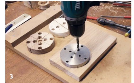
3. De boormal op een stukje iepenhout. Met een accuboormachine worden de 6 mm gaten geboord.
