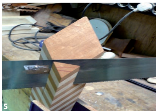
5 De binnenhoek afzagen, makkelijk voor het uithollen en noodzakelijk voor een prop van 50 x 50 mm voor het center.
