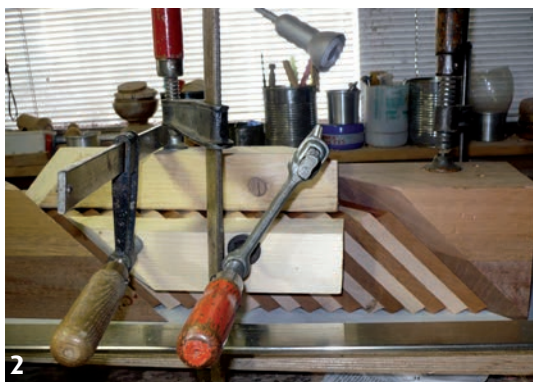
2 De lijnconstructie van beuken- en mahonie plankjes.
