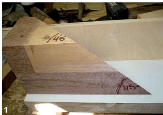
1 Dit hulpstuk / deze mal is onder 2 hoeken van 45° gezaagd voor het lijmp proces.
