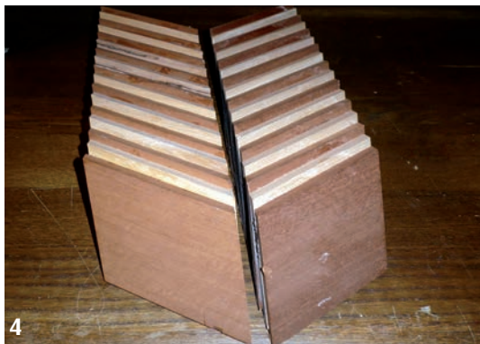
4 De binnenkant vlak en haaks maken met behulp van een vlakbank, de buitenkant op maat zagen met een cirkelzaag.
