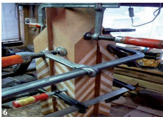
6 De vier delen worden aan elkaar gelijmd
