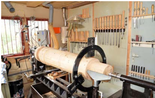
Omdat het kanon uit twee delen wordt opgebouwd moeten ze met pen en gat aan elkaar worden verbonden. Hier wordt de pen gedraaid. Een zware bril is nodig voor de ondersteuning.
