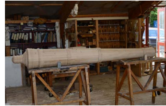
Op de werf werden beide delen definitief met lijm aan elkaar verbonden.
