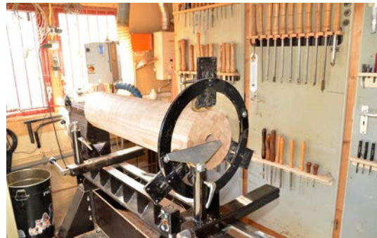
En hier, zonder tegencentra, wordt het gat gedraaid.
