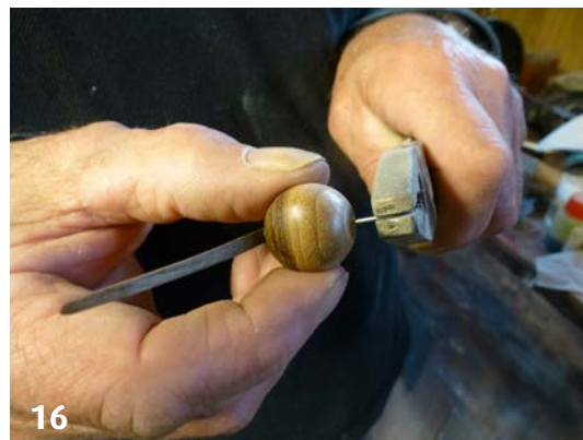
15. en 16. Ik boor in het kopje en het lijfje in het midden van het vlakke stukje een gaatje van 0.5 mm. (Het pinnetje maak ik van een kapotte elektrische muggenklapper.)
