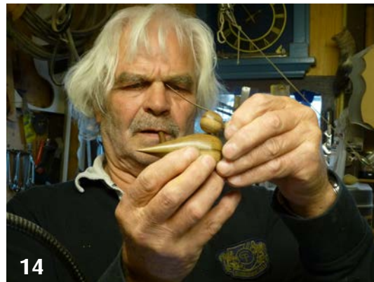
14. Ik kijk of de kop en het lijfje goed op elkaar passen, voordat ik ze aan elkaar bevestig.
