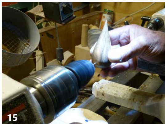
15. en 16. Ik boor in het kopje en het lijfje in het midden van het vlakke stukje een gaatje van 0.5 mm. (Het pinnetje maak ik van een kapotte elektrische muggenklapper.)
