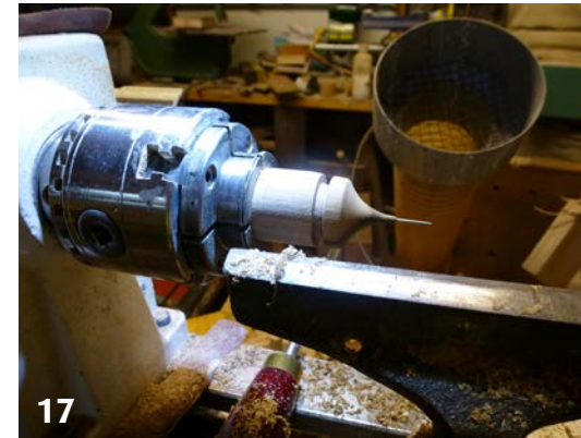
17. Het voetje is rondgedraaid, met de tegencentra boor ik een gaatje in het hart van het voetje. Ik zet het pinnetje vast met secondenlijm. Vervolgens draai ik het voetje verder af. In het lijfje moet ook een zelfde gaatje geboord worden, aan de onderkant.
