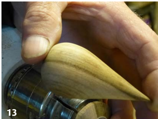
13. Het buikje is klaar na het excentrisch draaien.
