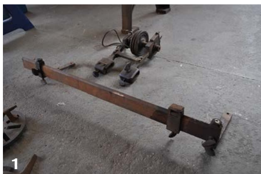
1. de vaste kop met een kort leren aandrijfriempje. Vermoedelijk is er later een elektromotor aandrijving geweest.
