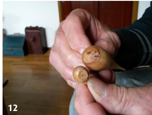
12. Om het kopje en de buik aan elkaar te bevestigen, schuur ik aan elk onderdeel een vlak stukje.
