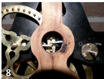
detail van de paletten die direct op de slinger zitten
