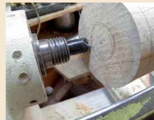
9 Center stevig inslaan omdat het hout excentrisch wordt ingespannen.
