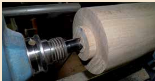
4 Passtuk (verzet) voor bevestiging in de chuck maken en opnieuw inspannen.
