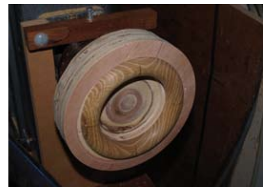
De torus gereed, met de index ring van de chuck is een 90° verdeling afgetekend
