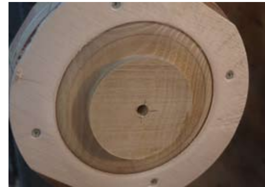
De schijf direct na het omkeren, het gat is van de schroefkop, de potloodlijn is de middencirkel
