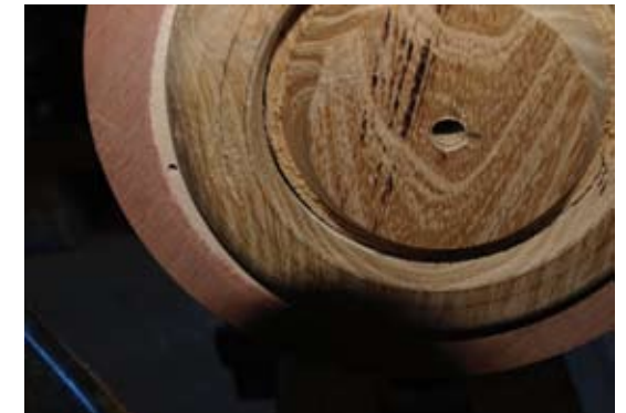
Op eigen klemming in het hulpstuk, het schuine vlak is er al, het centrum is los maar nog aanwezig.
