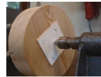
Het werkstuk op de vlakke schijf met het karton voor de mal
