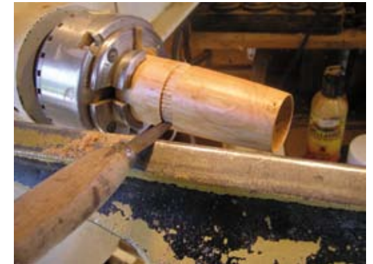
Foto 6. Decoratie aanbrengen, afwerken en afsteken. Het “flapperijzer” (voor de decoratie) kun je zelf maken uit b.v. een oud zaagblad of in dit geval een oud plamuurmes.
