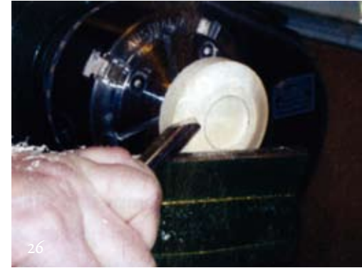
Foto 26 Span de voet op in de spankop en draai een kamertje waarin de contrastring past. Schuur en werk de voet helemaal af.
