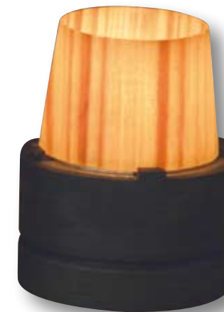
Foto 3 Een cilinder en een kapje van vurenhout met daarin een waxinelichtje. De cilinder is alleen afgewerkt met Deense olie. Dun vurenhout is van zichzelf al enigszins doorschijnend. Die doorschijn nam sterk toe na infiltratie met paraffine-olie kapje onder vacuüm. De kapjes met een doorsnede van 46 mm zijn geplaatst op een onderstel dat ventilatie van onderaf toelaat. Daardoor brandt de vlam veel rustiger.
