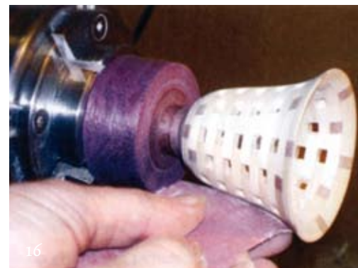
Foto 16 Schoor de buitenkant van de drinkbeker te beginnen met korrelgrootte 120 en daarna met opvolgende fijnere korrels. Eindig met korrel 600.
