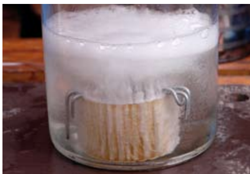
Foto 2. Een werkstuk ondergedompeld in warme paraffine-olie. Door vacuüm te zuigen komt lucht en waterdamp vrij.
