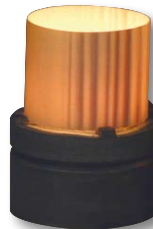
Foto 3 Een cilinder en een kapje van vurenhout met daarin een waxinelichtje. De cilinder is alleen afgewerkt met Deense olie. Dun vurenhout is van zichzelf al enigszins doorschijnend. Die doorschijn nam sterk toe na infiltratie met paraffine-olie kapje onder vacuüm. De kapjes met een doorsnede van 46 mm zijn geplaatst op een onderstel dat ventilatie van onderaf toelaat. Daardoor brandt de vlam veel rustiger.
