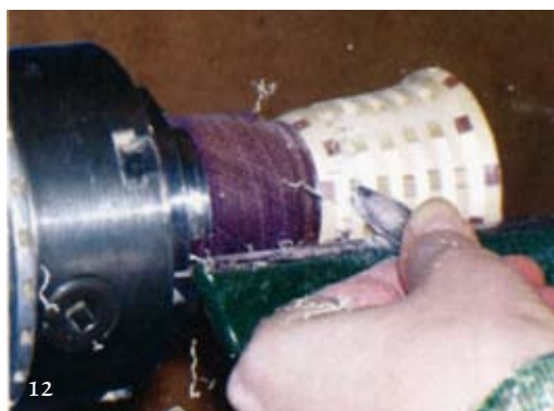
Foto 14 Werk de binnenkant af met een ronde neus schraper. Houdt de schraper onder een hoek van 45°, dat geeft een mooie gladde binnenkant.
