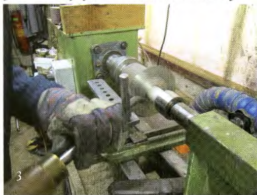
Het schijfje tin is met (kaars)vet ingesmeerd, de zelfgemaakte leunspaan met verstelbare pen is ingesteld, het 'optrekken' kan beginnen.
