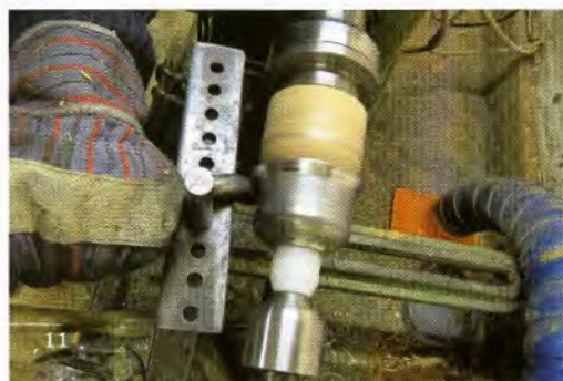
Het proces van bovenaf bekeken: er is nu ruimte om de bovenkant van het werkstuk een holle vorm te geven.
