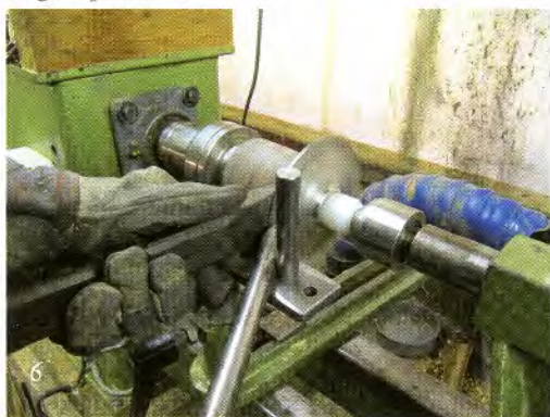
Met behulp van een hardhouten lat en het grote optrekstaal worden de ongewenste plooiingen gladgestreken.
