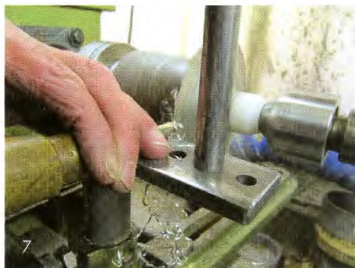
Het schijfje wordt tussentijds enkele malen bijgesneden met een afsnijbeitel.
