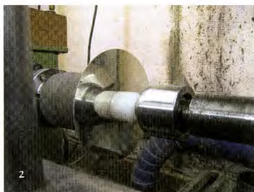
Het inspannen van het schijfje tin tussen de mal en het (nylon) regenter met dezelfde diameter als de kop van de mal.
