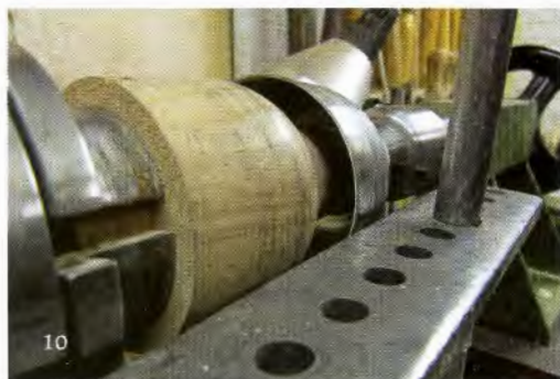
In deel II van het proces is de mal vervangen door een holle klos. De forceur werkt nu verder 'in de ruimte', wat bijzondere vakbekwaamheid vereist.
