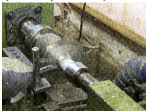
Met een 'forceerstaal' wordt het draaiende schijfje met enige kracht tegen de mal aangedrukt, een beweging die de nodige oefening vereist.
