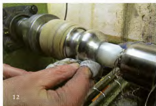
De bovenrand is keurig afgerond, het kaarsvet wordt weggepoest.
