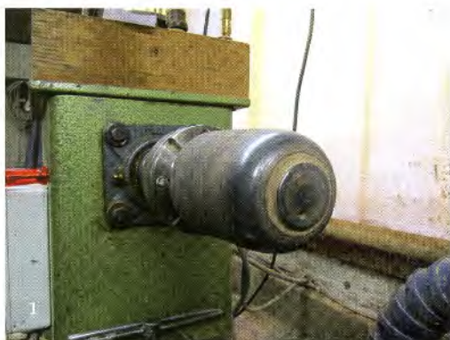
Een zelfgedraaide forceerklos of mal van beukenhout. Het boorgat is soms nodig bij het lossen van het metalen schaalkje.
