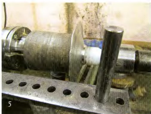
Door de krachten die vrijkomen bij het forceren kan het materiaal gaan 'fladderen'.
