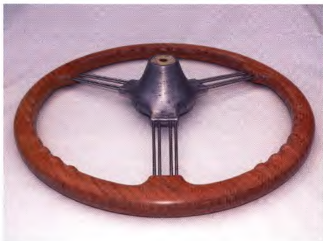
De onderkant van het stuurwiel met de uitgesneden nokjes
