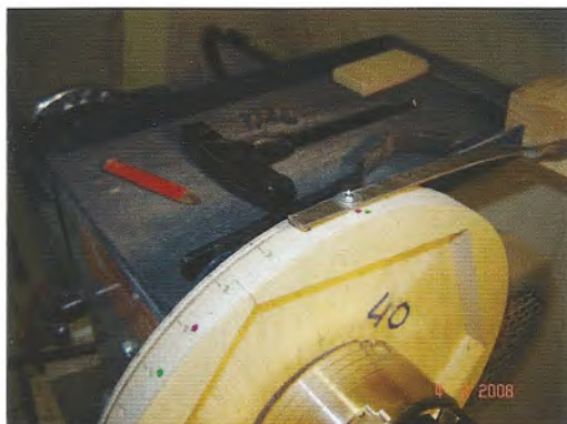
De manier waarop de schijf op de hoofdas achter de klauwplaat zit + een beeld van het blokkeermechanisme.
