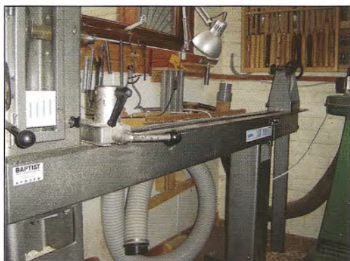
foto 4: het verlengde bed van de draaibank.
