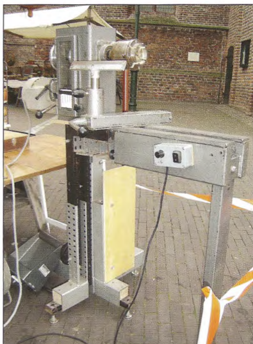
foto 5: het 'dwarsbed' is het hoofdbestanddeel van een kleine demonstratie draaibank. De poot rechts is onderdeel van de buitendraaiinrichting.
