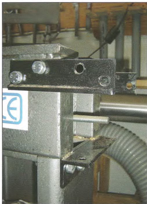
foto 3: aan het eind van het bed maakte ik drie hoeklijntjes en een stuk draadeind M10 vast. Daarmee is het dwarsstuk als verlenger van het bed te gebruiken
