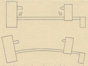
Beter is het wanneer de motorkant op het bed vastzit evenals de voet aan het uiteinde.Voor heel nauwkeurig werk is het fijn als één van de gelei-dingsstaven is gedraaid zodat één vierkante en één ruit-vormige geleiding ontstaat. De losse kop zit daarmee zeer nauwkeurig vast en kan niet zijdelings verschuiven. tek. 2
